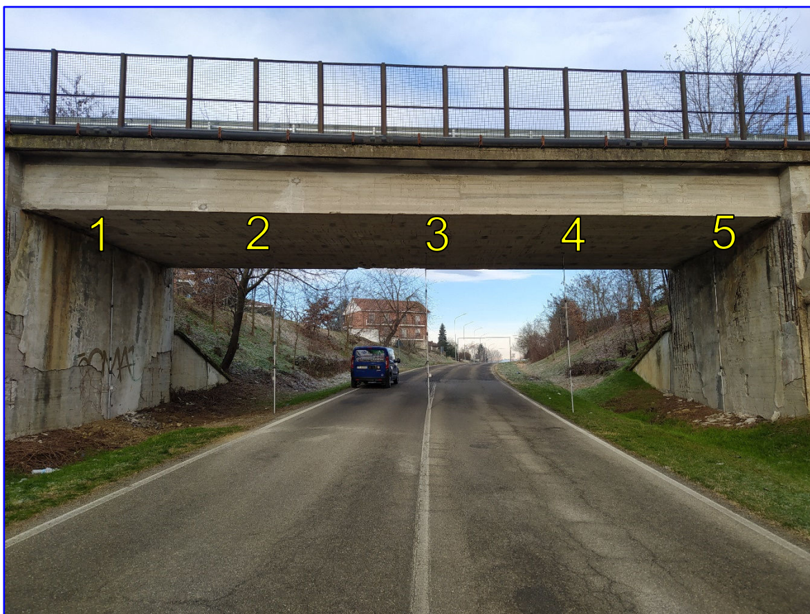
Vista dei sensori montati su aste telescopiche
