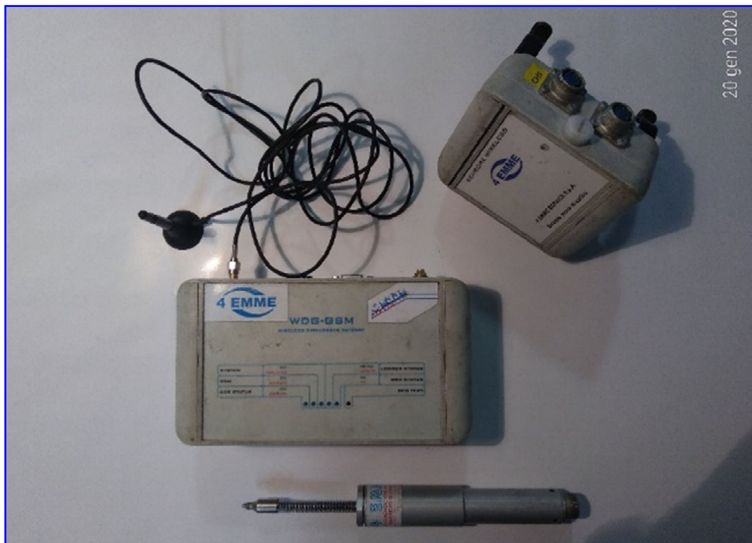
La centralina ricevente, un'unità di trasmissione e un potenziometro
