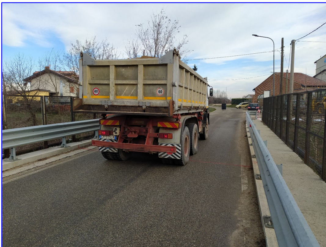
Vista dell'autocarro 1 con gli assi posteriori nella mezzeria del ponte
