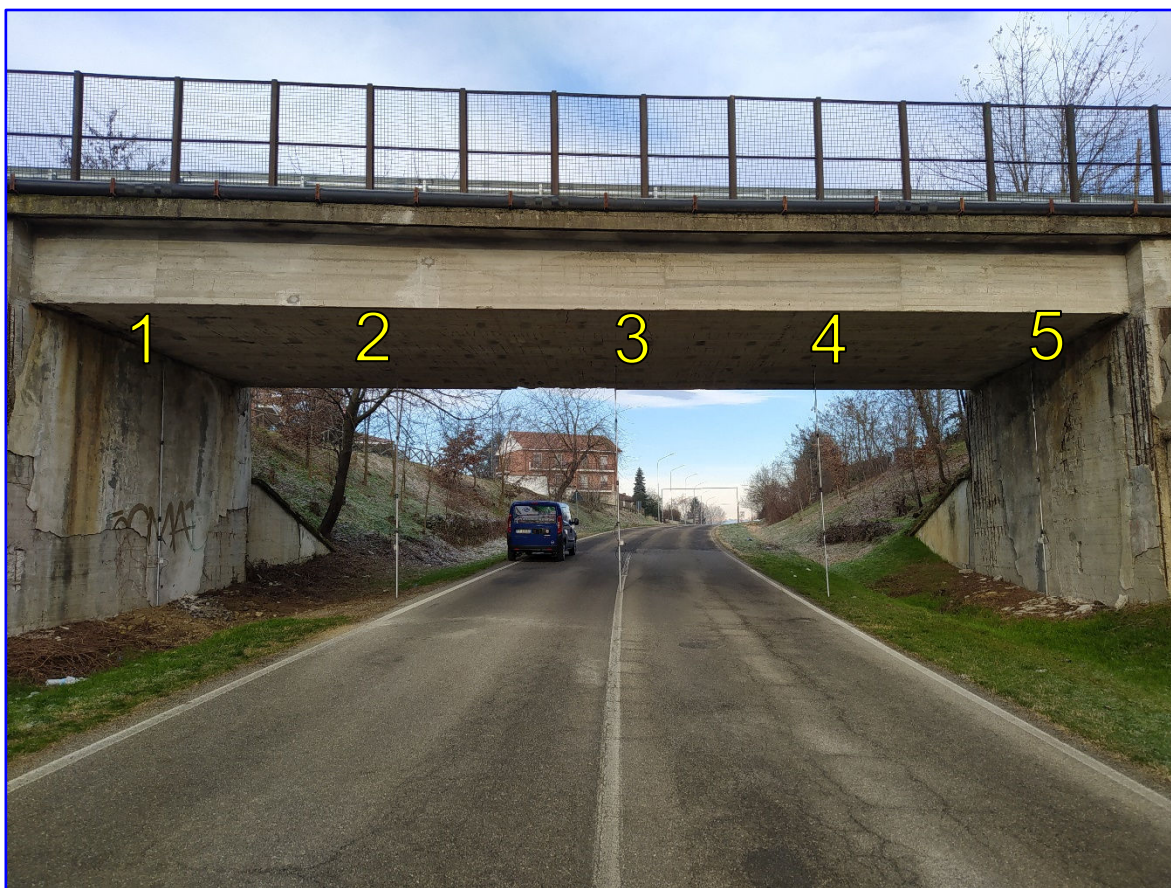
Vista dei sensori montati su aste telescopiche
