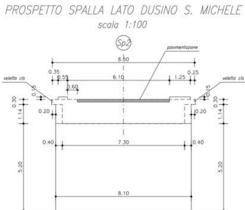
Figura 6.2 – Carpenteria spalla lato Dusino San Michele
